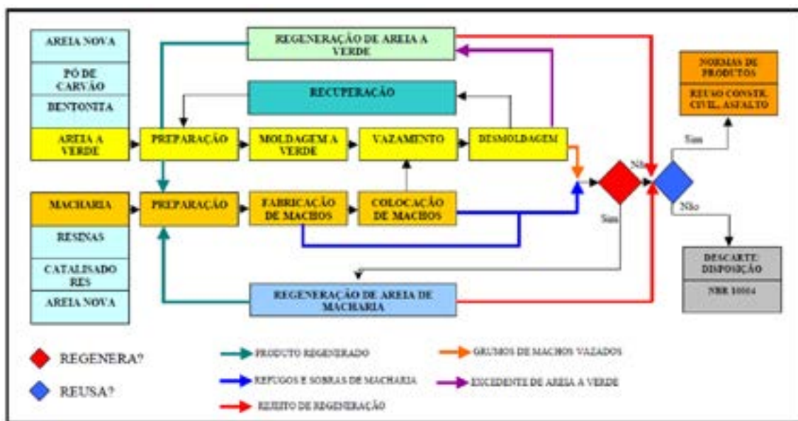
Figura 2 – Processo de fundição (GOSSEN, 2005)
