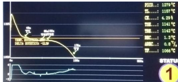
Figura 10 – Curva de resfriamento após correções na composição química, na carga metálica e nas correções no metal líquido. (6)
