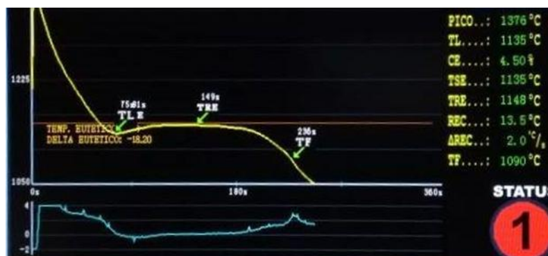
Figura 8 - Curva de resfriamento (linha amarela) e sua derivada (linha azul) de um metal hipereutético. (6)
